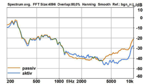
Exzellente Sprachverständlichkeit (98,2%) und gute Sprachqualität (3,6). Dämpfung von durchschnittlich -16,2 dB. Die maximale Pegelsenkung beträgt jedoch mehr als -45 dB, was das beste Ergebnis im Test ist.
