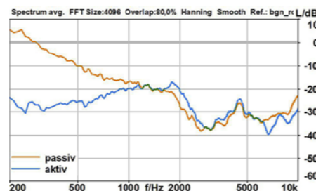
Sehr gute Sprachverständlichkeit von 95,8 % und eine gute Sprachqualität (3,8). Geringe Dämpfung im Passivbetrieb (Ø: -5,5 dB), aber mit überdurchschnittlicher Performance im aktiven Modus (-24,3 dB) und hoher Toleranz gegen Fehlpositionierung (3,7 dB) der Ohrmuscheln. Das Mikro reagiert durchschnittlich auf Fehlpositionierung und Mundabstand.
