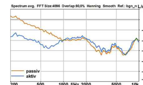
Das DC ONE-X überzeugt mit sehr guten Sprachverständlichkeits- (91,4 %) und -qualitätswerten (4,2). Die Dämpfung im passiven Modus ist eher gering (Ø: -6,5 dB), im aktiven Modus hingegen überzeugt sie (Ø: -20,1 dB). Das Headset ist tolerant gegen Fehlpositionierung der Ohrmuscheln (3,5 dB). Das Mikrofon hingegen reagiert sehr empfindlich bei falscher Positionierung und bezüglich des Abstands zum Mund des Piloten.
